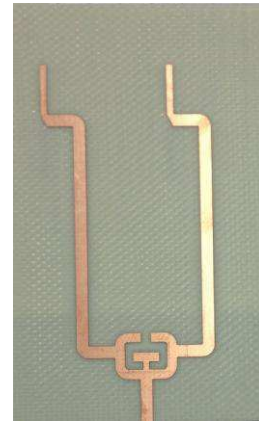
FIGURA 32: UMA TOPOLOGIA REALIZADA: UM DP COM DUAS ANTENAS.
