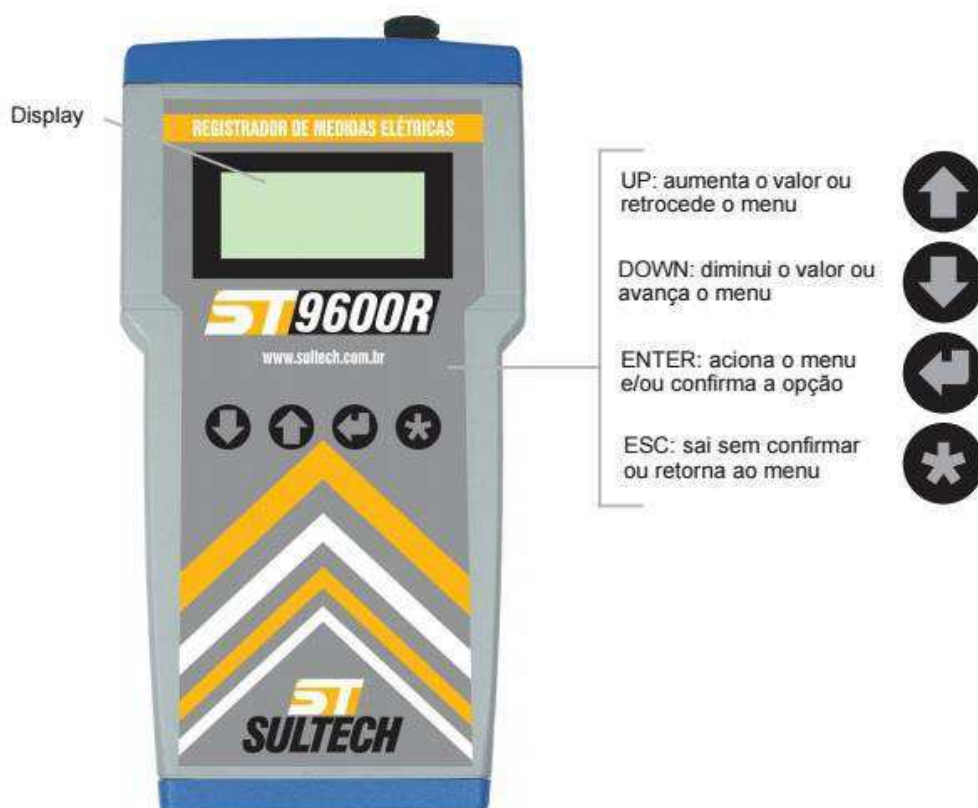
Figura 10 - Imagem ilustrativa de registrador de grandezas elétricas.
