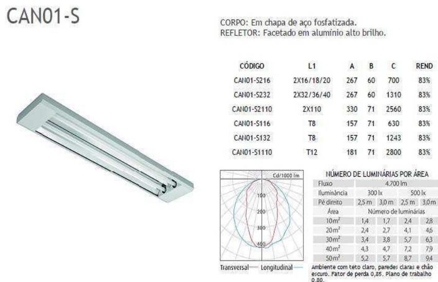
Figura 4. Especificação da Luminária Fluorescente.
