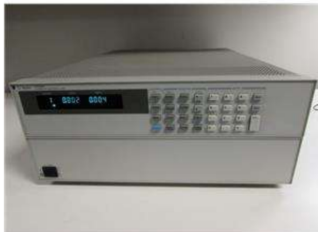
Figura 3.7 - Fotografia da carga DC
