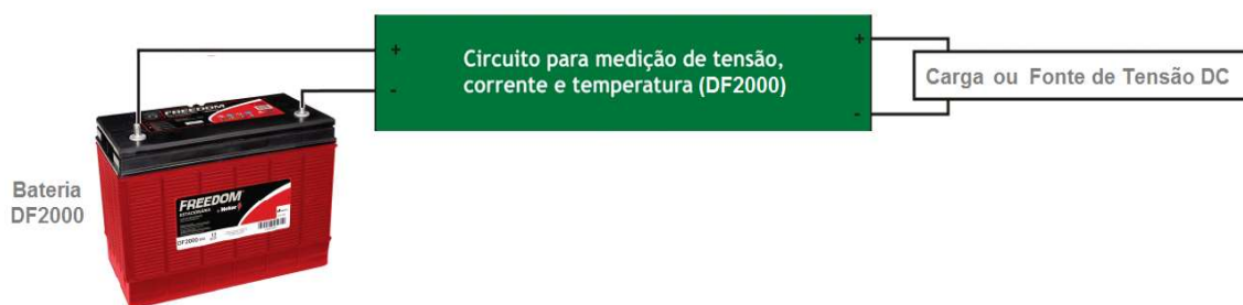
Figura 3.10 - Representação em diagrama de blocos do circuito de medição proposto
