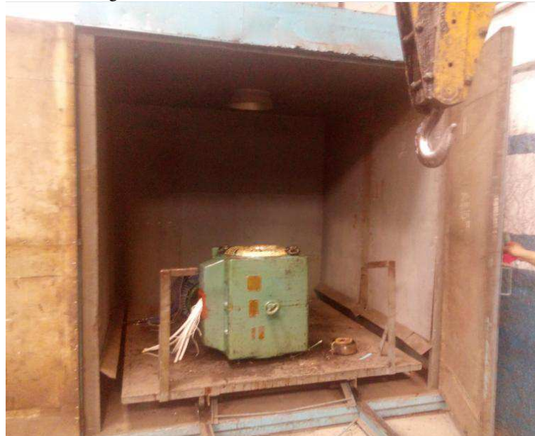
Figura 76: Processo de Cura do verniz na estufa
