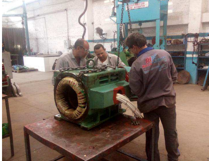
Figura 79: Inspeção elétrica e mecânica antes do processo de montagem
