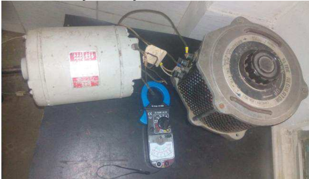
Figura 35: Montagem de ensaio de rotor falhado
