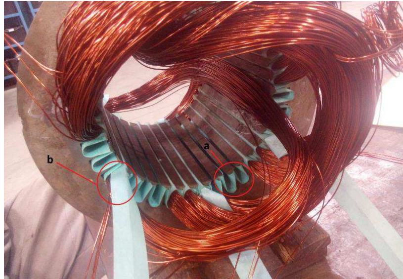
Figura 15: Isolamentos da ranhura do estator. a) Isolamento entre a bobina e a ranhura. b) Isolamento de fechamento da ranhura
