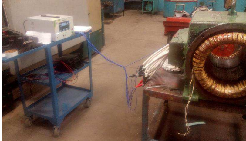
Figura 77: Teste de resistência de isolamento e resistência ôhmica, utilizando o Surge Test
