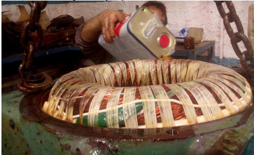
Figura 75: Aplicação de Verniz isolante
