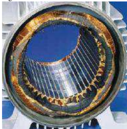
Figura 58: Desbalanceamento de Tensão
