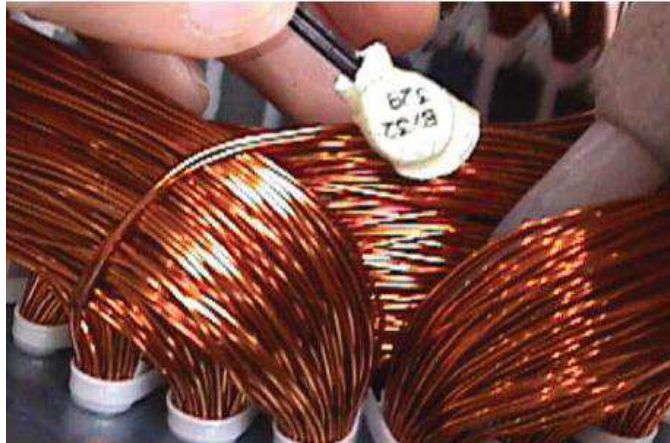
Figura 23: Termostato sendo instalado na cabeça da bobina
