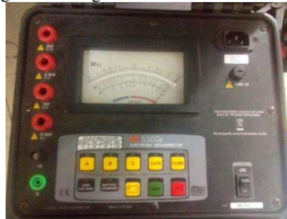
Figura 28: Megôhmetro - Modelo Mi5500e
