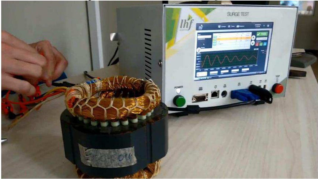
Figura 44: Teste em estator utilizando Surge-Test
