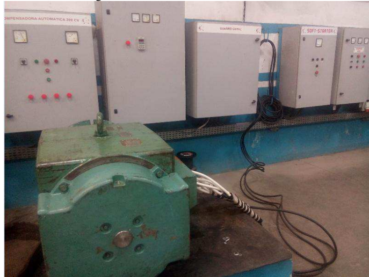
Figura 86: Partida utilizando Soft-Start
