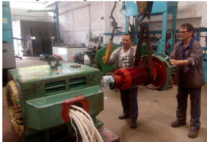
Figura 80: Montagem do conjunto rotor e estator
