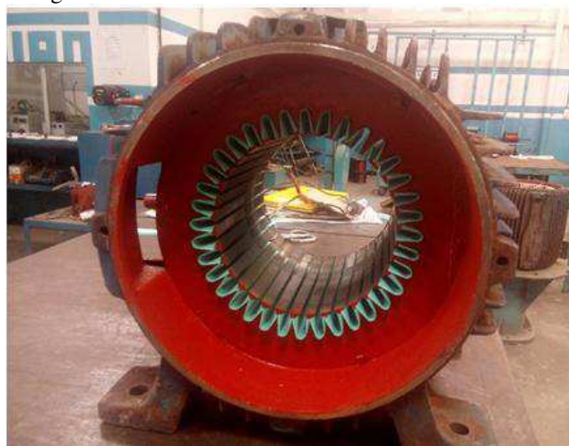
Figura 7: Estator com isolamento de fundo de ranhura
