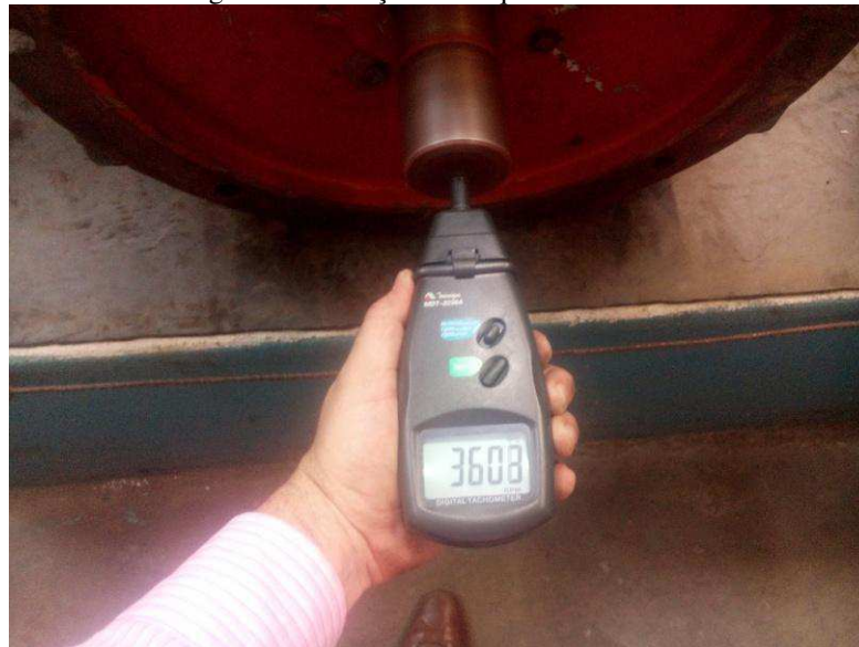
Figura 87: Medição da frequência nominal
