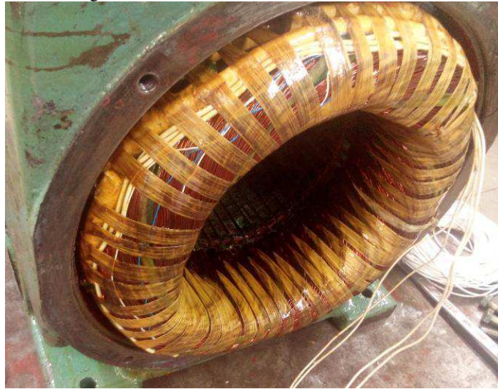
Figura 73: Sensores térmicos Pt-100 instalados
