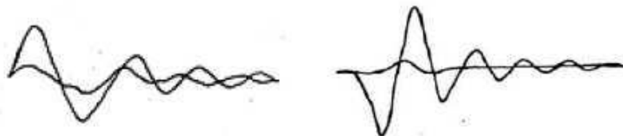
Figura 49: a) Curto parcial para massa. b) Curto total para massa
