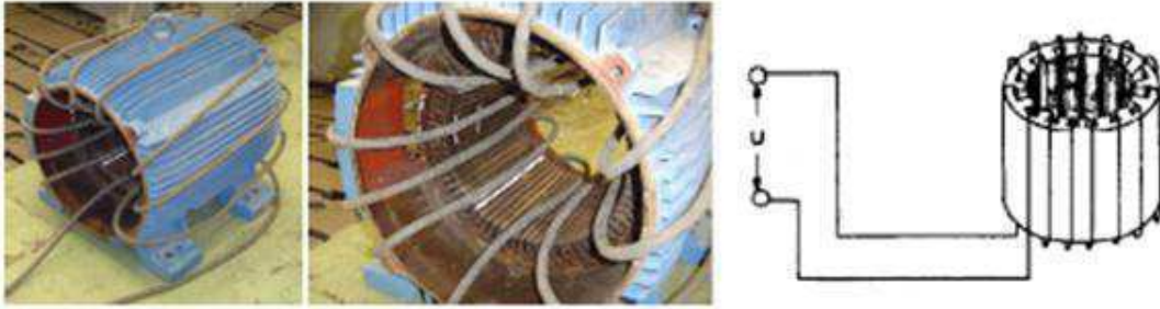
Figura 40: Montagem do solenóide da carcaça do motor
