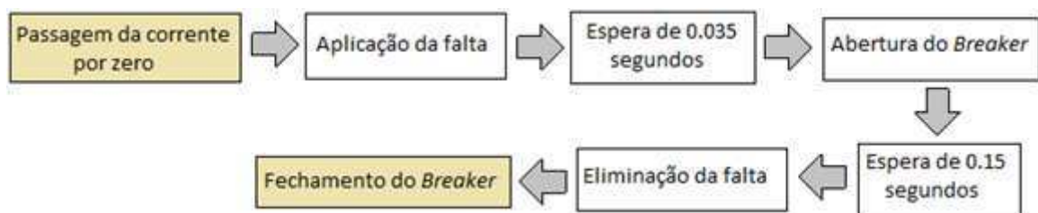
Figura 3.15 - Lógica sequencial de eventos do controlador.
