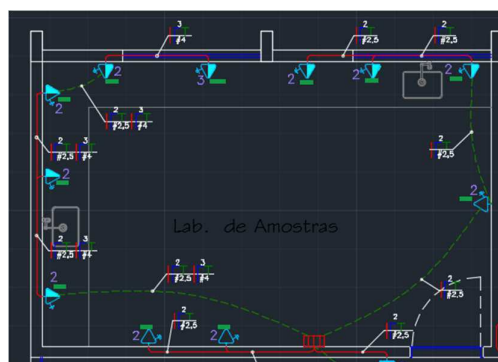
Figura 5 - Projeto Elétrico - Força
