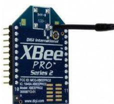
Figura 45 Dispositivo ZigBee XBP24-ZB [32].
