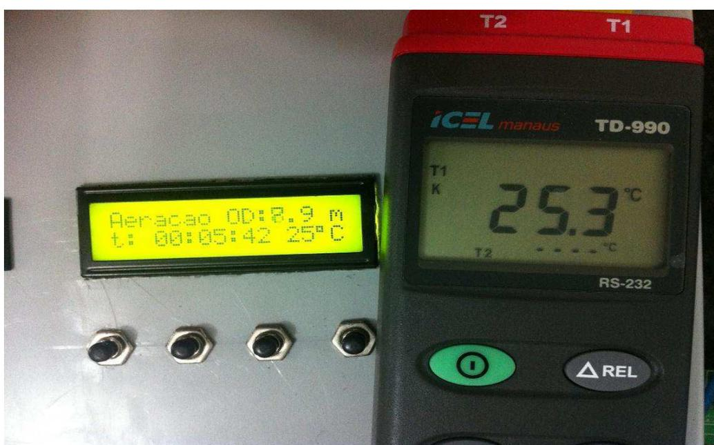
Figura 64 Validação do sensor de temperatura.
