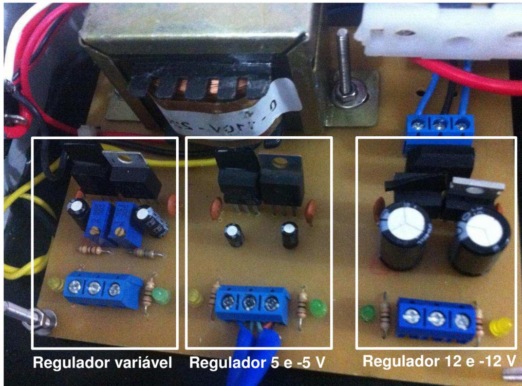
Figura 58 Placa da fonte de alimentação.
