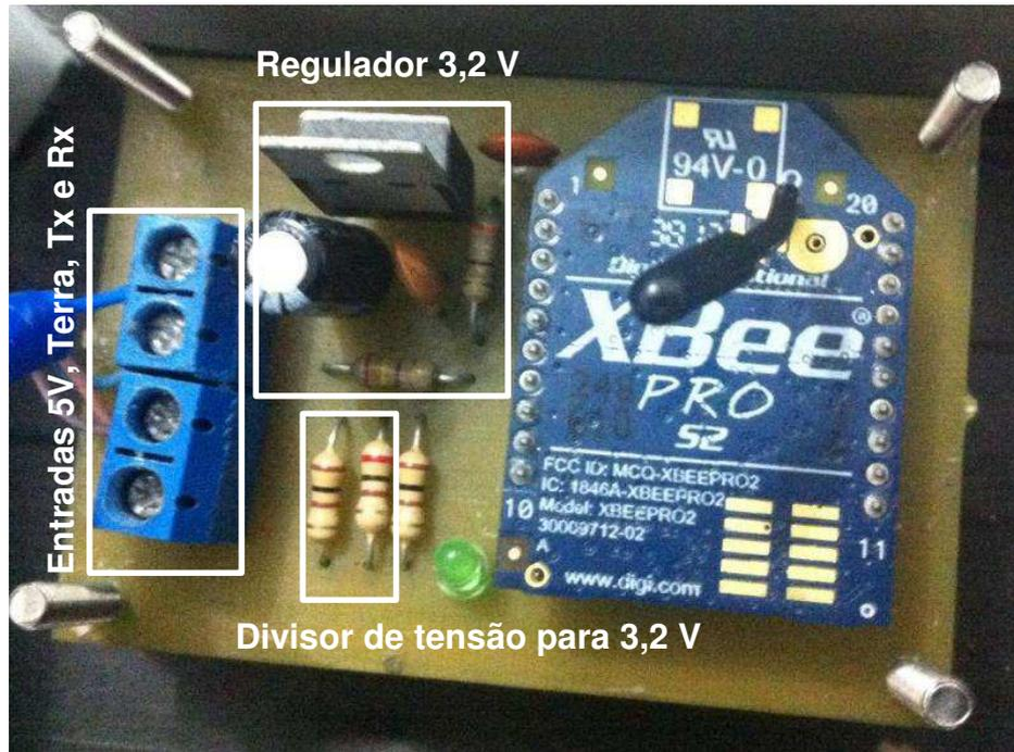
Figura 59 Placa da comunicação XBee.
