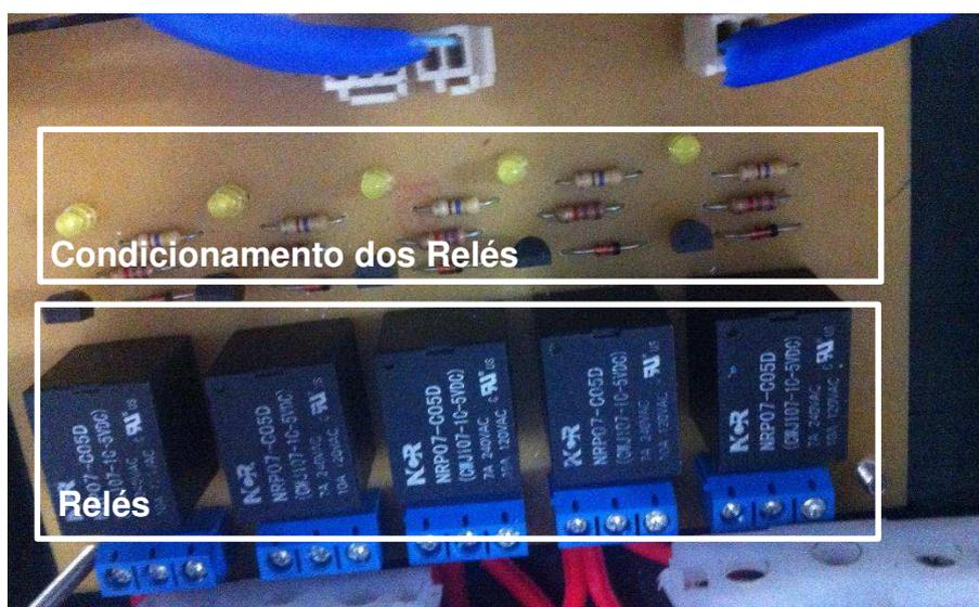
Figura 61 Placa de acionamento dos relés.
