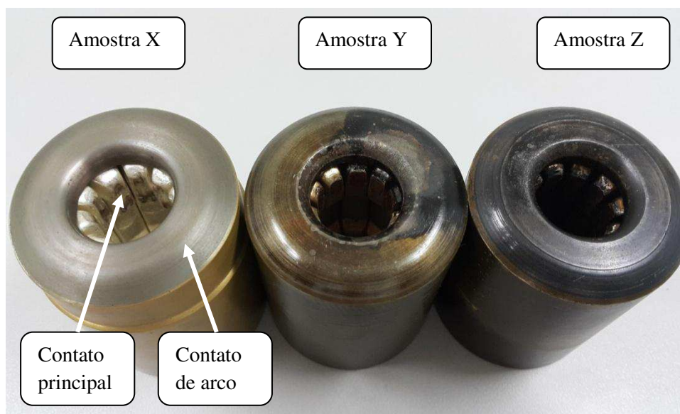
Figura 4.3: Amostras de contato fixo do disjuntor A.
