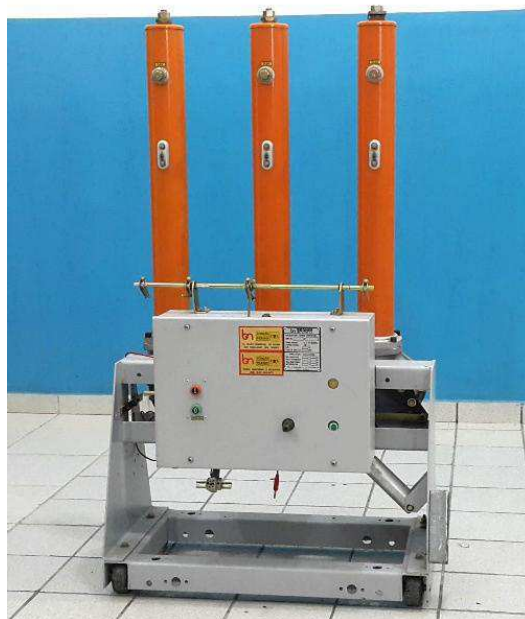
Figura 4.2: Fotografia do disjuntor B.
