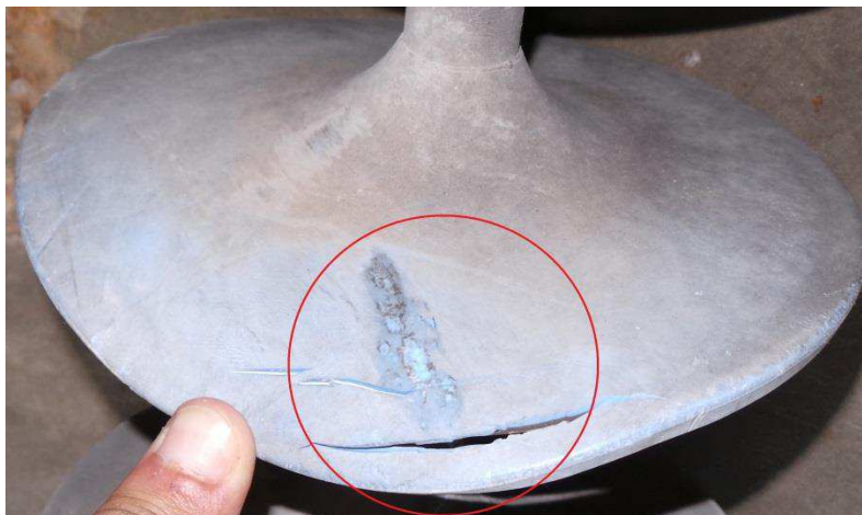
Figura 5.5. Fotografia do estado de degradação das aletas, com rachaduras circulares em vermelho.
