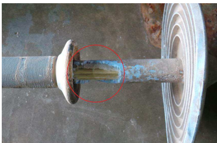
Figura 5.1. Fotografia de núcleo exposto, destacado dentro do círculo vermelho.
