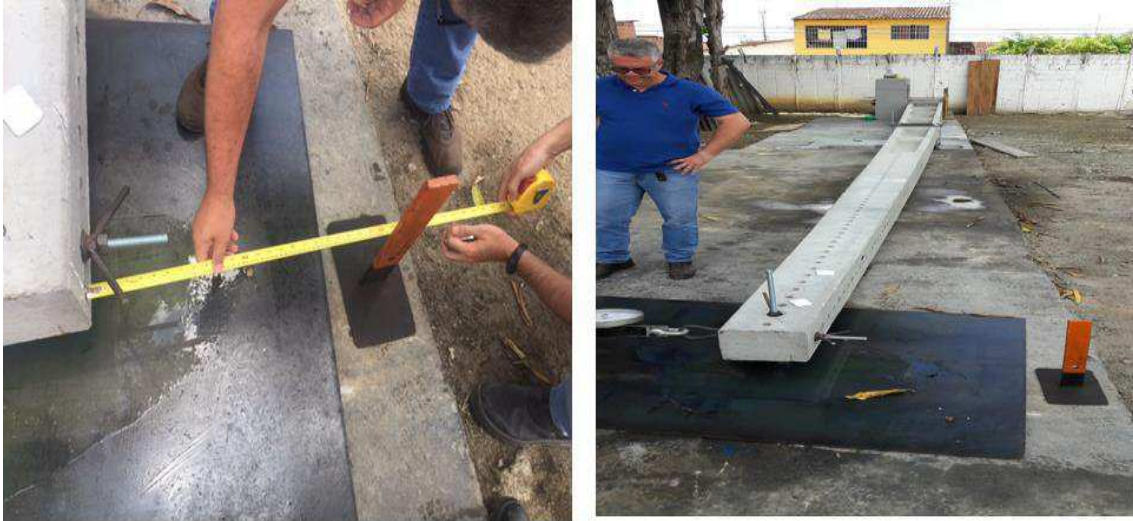
Figura 5: Ensaio em poste de concreto armado.
