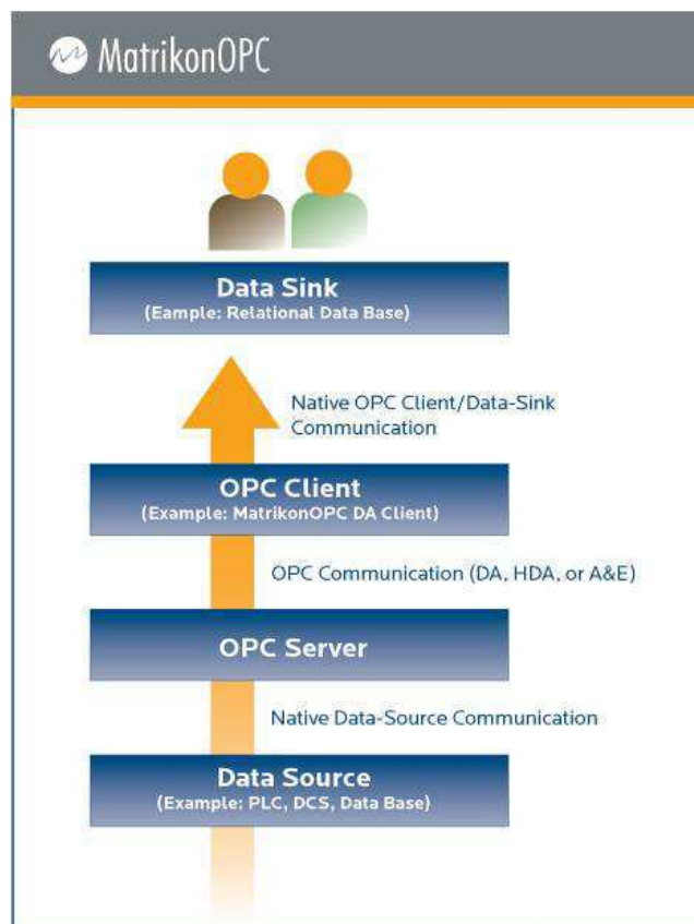
Figura 2: Diagrama arquitetural do protocolo OPC. Fonte: [3].
