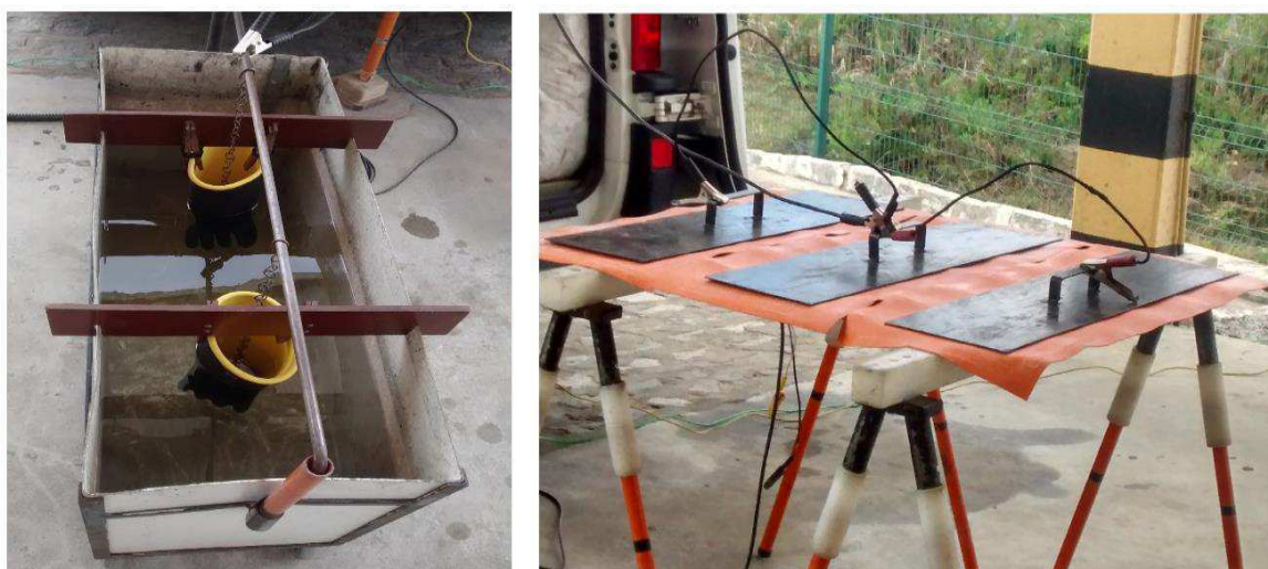
Figura 3.7: Ensaio em luvas e em mantas
