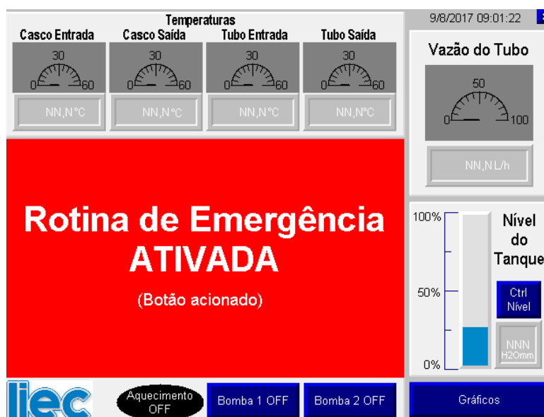
Figura 20 - Interface do IHM para a rotina de emergência ativada
