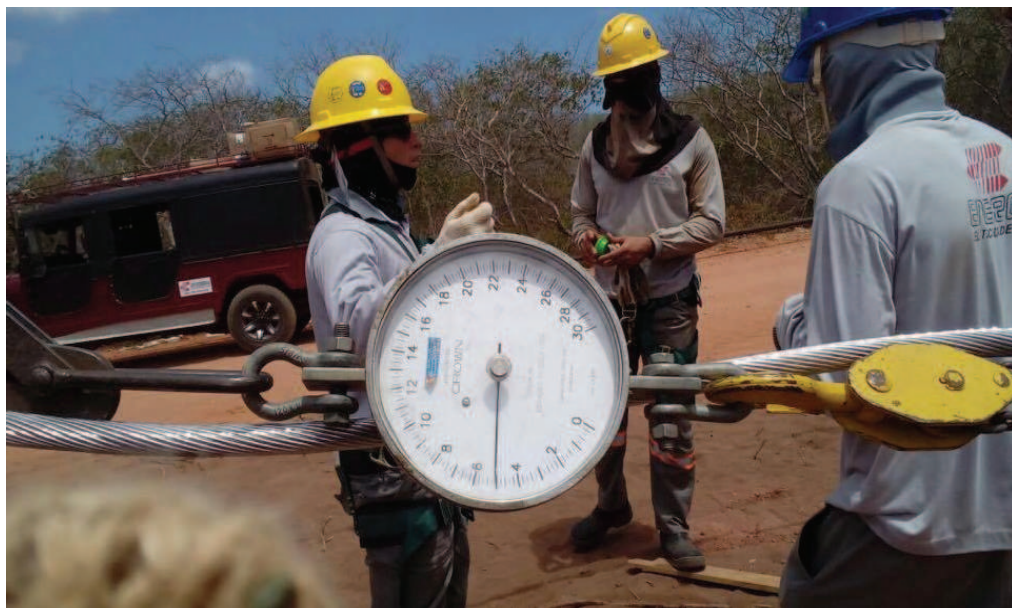
FIGURA 10- MEDIÇÃO DA TENSÃO MECÂNICA ATRAVÉS DE UM DINAMÔMETRO
