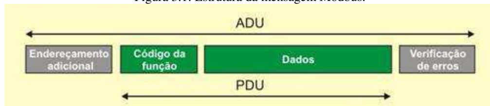
Figura 3.1: Estrutura da mensagem Modbus.
