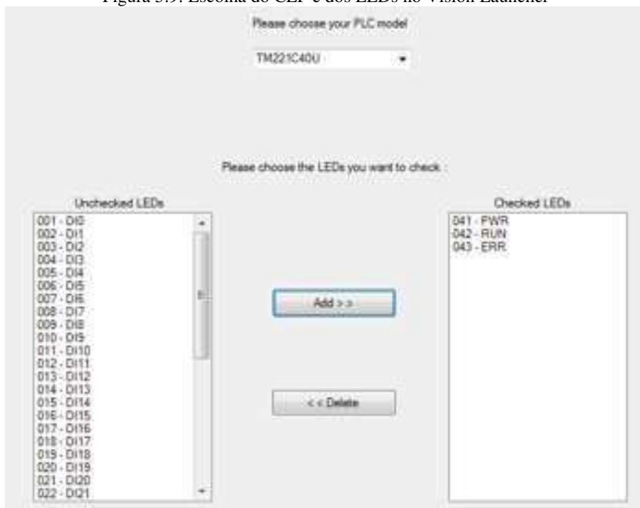
Figura 5.9: Escolha do CLP e dos LEDs no Vision Launcher
