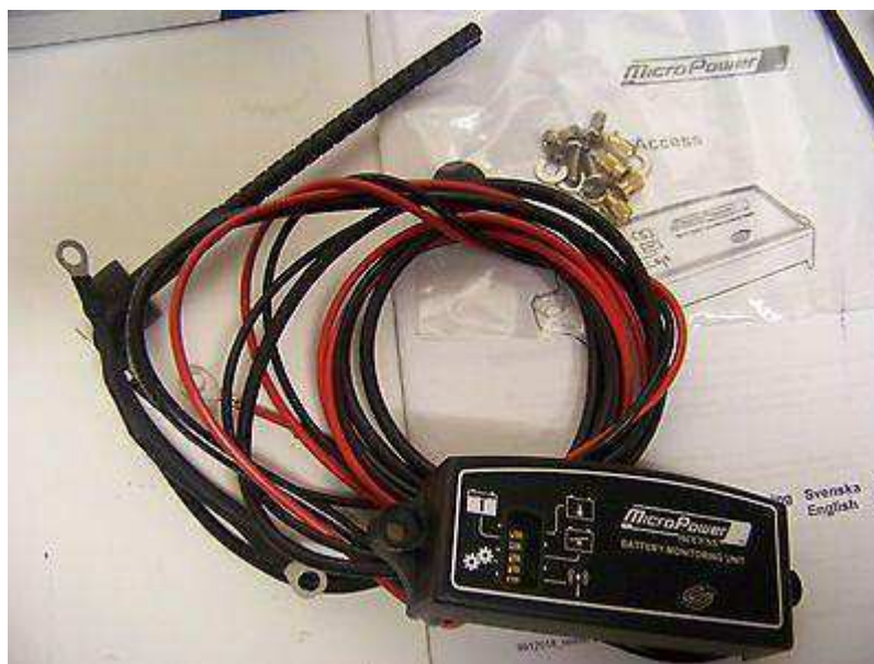
FIGURA 15 – BMU (PRÓPRIO AUTOR).
