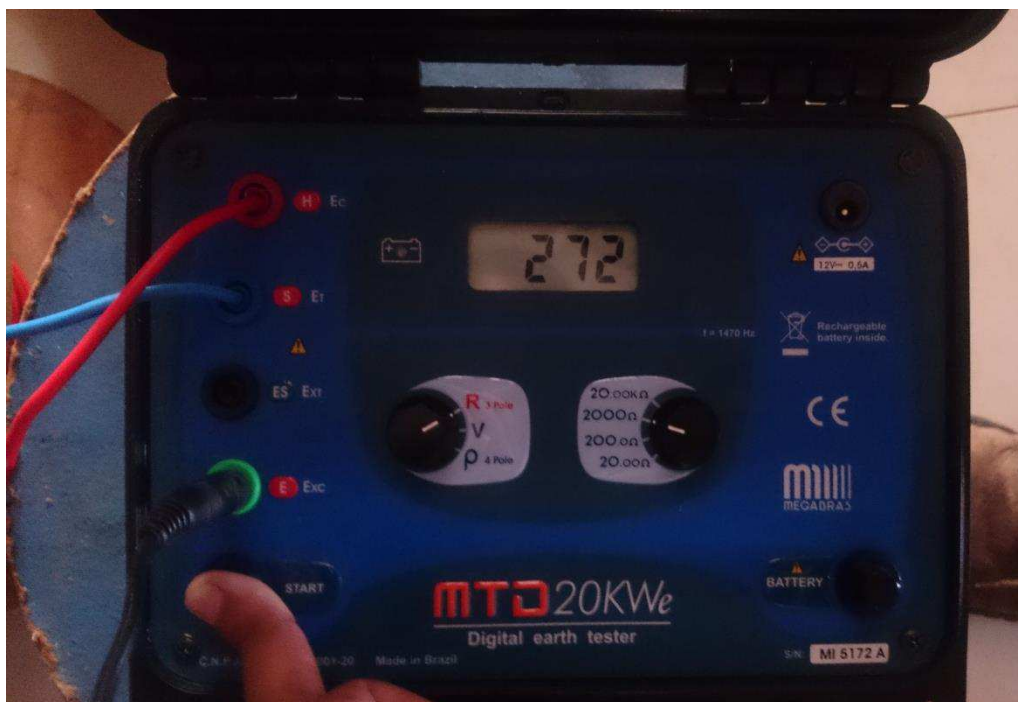
Figura 16– Ensaio de resistência de aterramento
