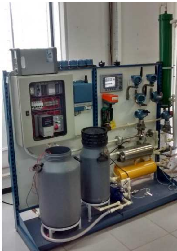
Figura 4 – Trocador de Calor Casco e Tubos (ASSIS, 2015)
