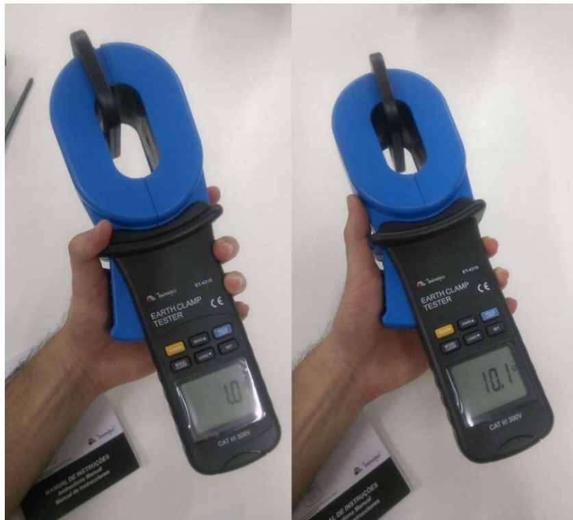
Figura 8 - Testes de medição de resistência de 1 \Omega e 10 \Omega .
