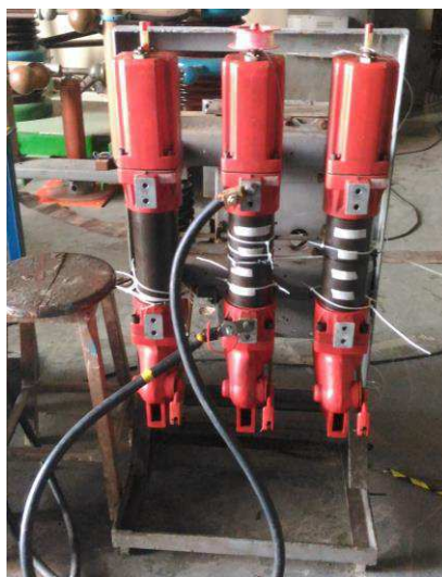
Figura 4. Disjuntor trifásico do tipo PVO.
