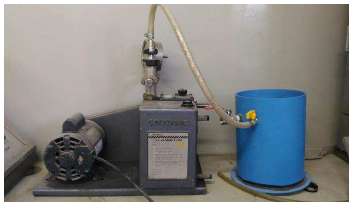
Figura 7. (a) Bomba à vácuo e (b) Filtros utilizados na bomba à vácuo.
