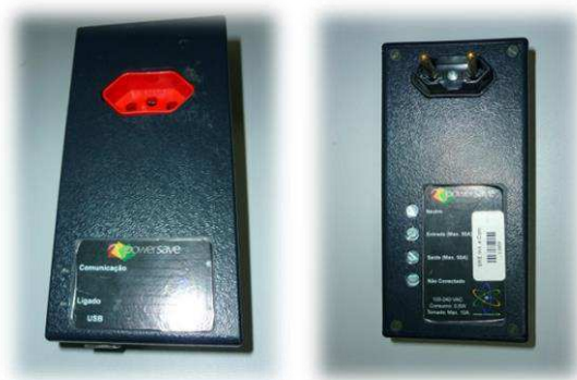
Figura 7- Modelo de Multimetro Powersave utilizado nas medições.
