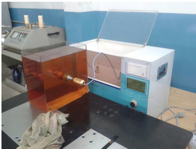
Figura 18 – Estrutura preenchida com o óleo isolante e medidor de rigidez dielétrica utilizado para a aplicação da tensão.
