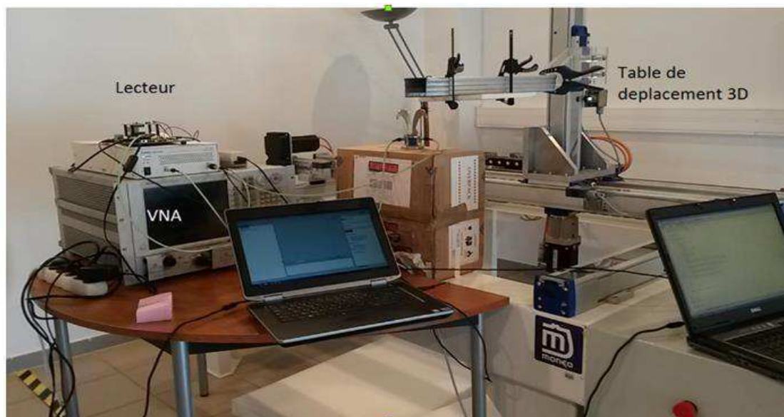
FIGURA 41: BANCO DE MEDIÇÕES BASEADO NUMA MESA DE DESLOCAMENTO 3D, PLATAFORMA ESYNOV.
