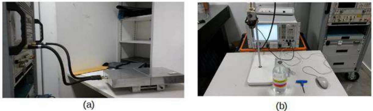
FIGURA 5: MÉTODOS DISPONÍVEIS PARA A CARACTERIZAÇÃO DOS MATERIAS SAINT-GOBAIN. (A) MÉTODO DA CAVIDADE RESSONANTE, (B) MÉTODO DA SONDA COAXIAL.
