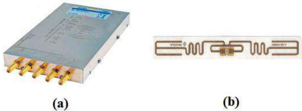
FIGURA 2: EXEMPLO DE UM LEITOR RFID (A) E UMA ETIQUETA RFID COM CHIP (B)
