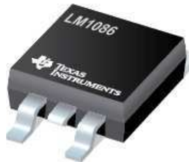
Figura 2.17 – Regulador de tensão LM1086
