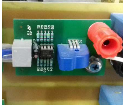
Figura 2.16 – Sensor de Corrente LTS15-NP
