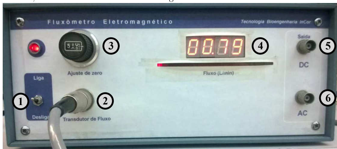
Figura 5.16: Módulo do fluxômetro eletromagnético: 1 - chave liga/desliga; 2 - conector do transdutor de fluxo; 3 - ajuste do zero; 4 - mostrador digital do fluxo; 5 - saída do sinal de fluxo média; 6 - saída do sinal de fluxo analógica.
