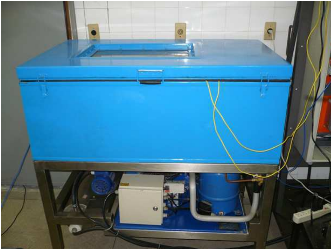
Figura 4.1: Fotografia do tanque hidrotérmico empregado no isolamento e controle de temperatura
