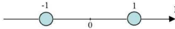
Figura 3.10 Diagrama de constelação para um sinal com modulação BPSK (extraído de (HAYKIN, 2002)).
