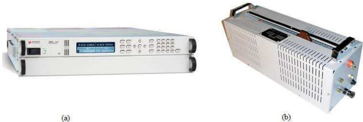
Figura 6.17 – Equipamentos utilizados no experimento para compor o sistema FV: (a) emulador FV E4360 e (b) reostato MOD LAB-N12S.
