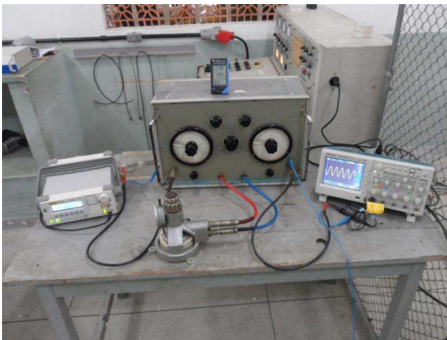
Figura 17 – Medição da constante dielétrica em laboratório (a) Ponte Schering (b) Capacitor de placas paralelas
