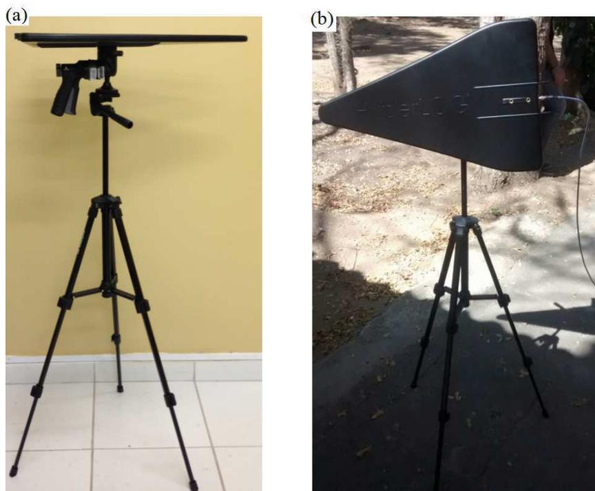
Figura 9: Medições da potência do ambiente. (a) Medição *indoor*. (b) Medição *outdoor*.
