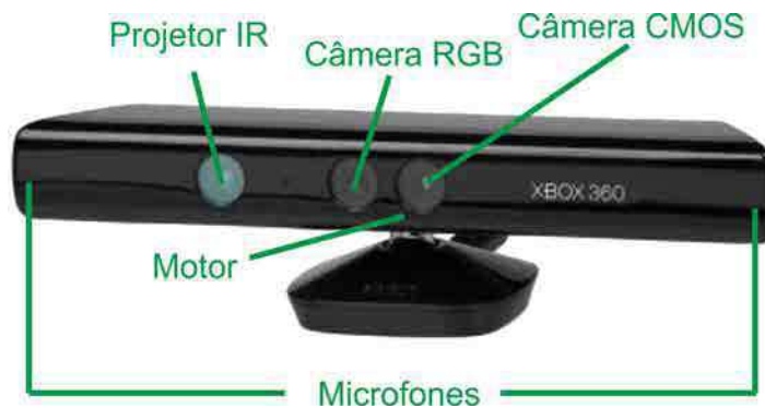
Figura 4.3: Sensor Kinect, indicando o atuador e sensores presentes.
