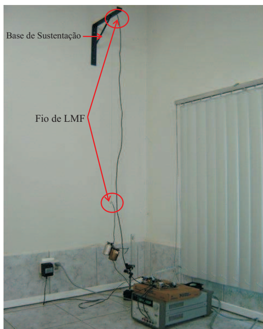
Figura 4.1: Foto da plataforma utilizada para treinamento termomecânico dos fios de LMF.
