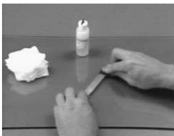
Figura A.13: Lixando a superfície de fixação do extensômetro.
