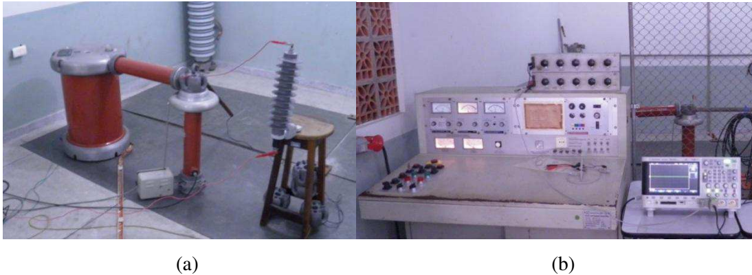
Figura 5.5 – Fotografias: (a) Kit de alta tensão. (b) Mesa de controle e osciloscópio para aquisição de dados.
