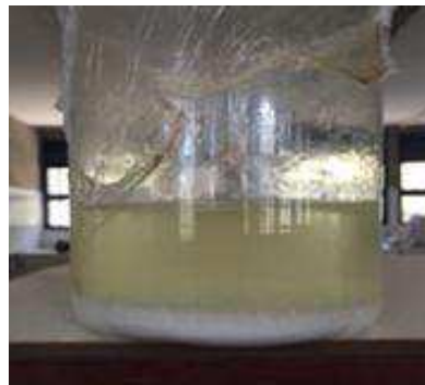
Figura 10 - Solução de cloreto de estanho com cristais de cloreto de chumbo precipitados.
