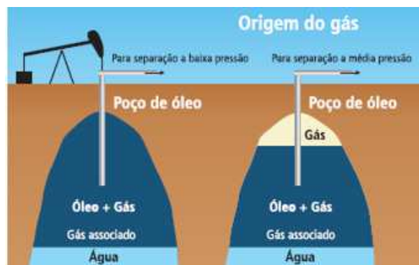
Figura 2.3: Fluxograma simplificado de Poços de Gás Associado. Fonte: Adaptado do livro "Gás Natural" da Bahiagás
