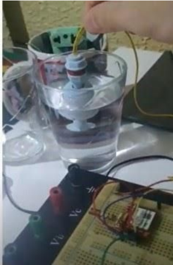
Figura 9 - Sensor de nível de água dentro do recipiente com água.
