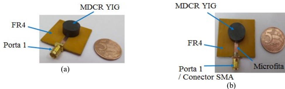
Figura 5.1 – Protótipo fabricado da MDCRA para excitar o modo \text{HEM}_{118} : (a) vista isométrica (b) vista superior e (c) vista inferior
