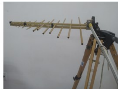
Polarização do campo elétrico no plano horizontal
