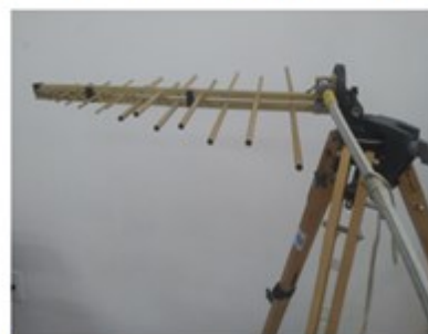
Polarização do campo elétrico no plano horizontal
