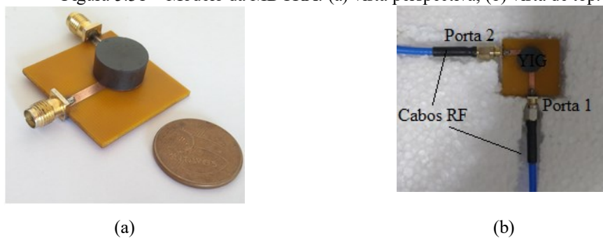
Figura 5.31 – Modelo da MDCRA: (a) vista perspectiva, (b) vista de top.
