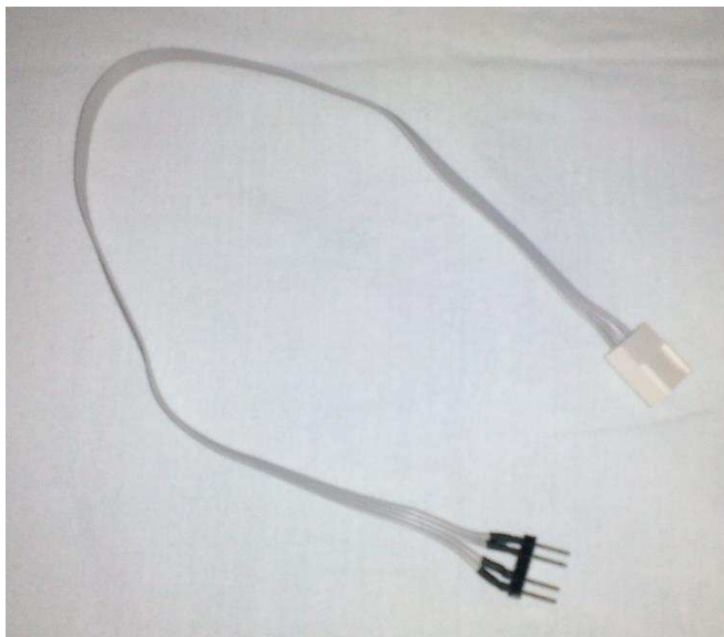
Figura 20 - Conector para conectar o circuito driver com o Arduino.
