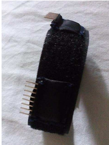
Figura 12 - Acelerômetros acoplados a pulseira de velcro.
