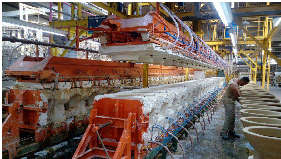
Figura 14. Fotografias da etapa do acabamento das bacias.
