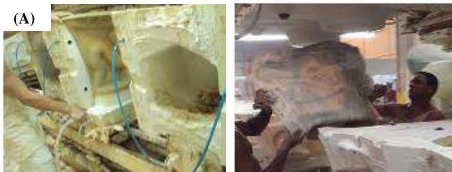
Figura 13. Fotografias da (A) Abertura do molde e do (B) Desmoldeamento da peça.
