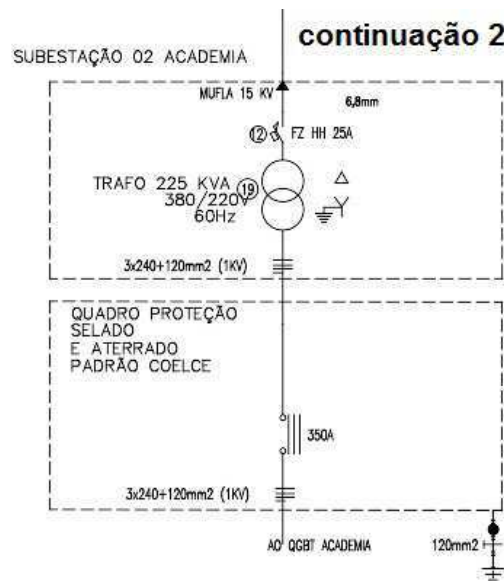
Figura 8 – Continuação 2 do diagrama unifilar da subestação compartilhada.
