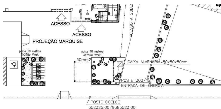
Figura 12 – Malha de aterramento localizada sob o poste de entrada do ramal de ligação.
