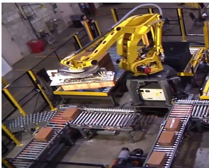
Figura 7 Robô Paletizador em funcionamento
