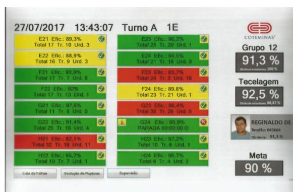
Figura 24: Supervisório Do Setor De Tecelagem
