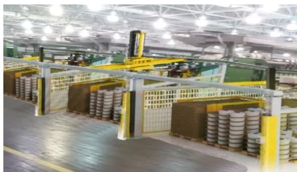
Figura 9 Sistema de guindaste com trilho fixo
