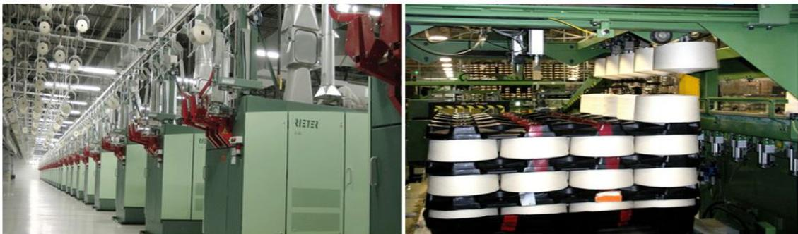
Figura 8 Sistema de transporte suspenso com área de paletização dedicada
