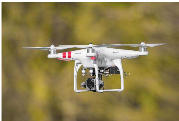
Figura 2 - VANT de asa rotativa com uma câmera fotográfica acoplada.
