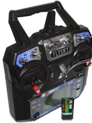
Figura 21 - Conjunto RC/Receptor 6ChFlysky.
