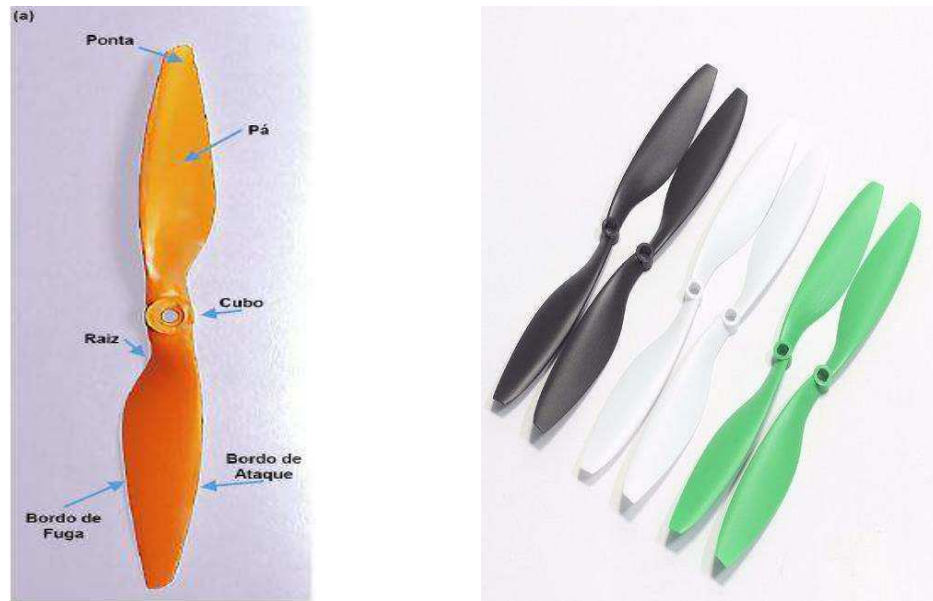
Figura 8 - Descrição de uma hélice; exemplos de hélices para VANTs.
