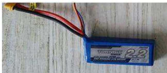
Figura 27 - Bateria LiPO de 2200 mAh utilizada no VANT Asa.
