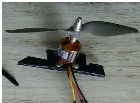
Figura 24 - Motor Brushless de 1800KV acoplado a hélice 9x6.
