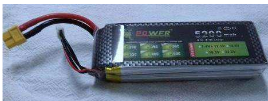
Figura 20 - Bateria LiPO de 5200mAh utilizada no VANT Quadricóptero.
