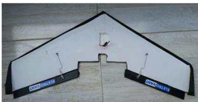
Figura 22 - Estrutura para o projeto do VANT Asa.
