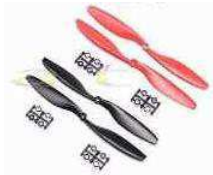
Figura 17 - Hélices 10x4,5 utilizadas para o projeto do Quadricóptero.
