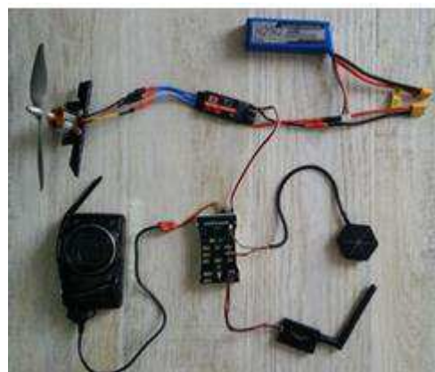
Figura 33 - Controladora de voo, Pixhawk, sendo conectada aos outros componentes.
