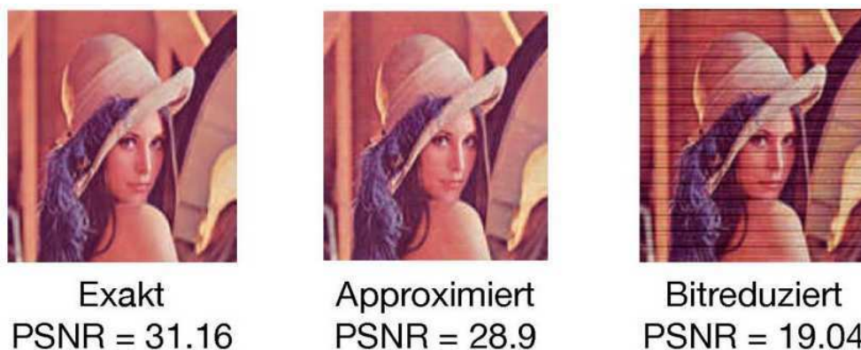
Figura 3: Qualidade de imagem com aritmética exata, aproximação dos 8 bits LSB e implementação de largura de bit reduzida (fonte: [1]).
