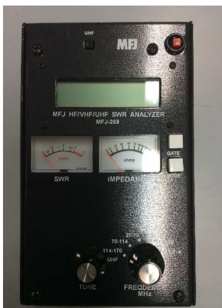
Figura 2.2 – Medidor de SWR
