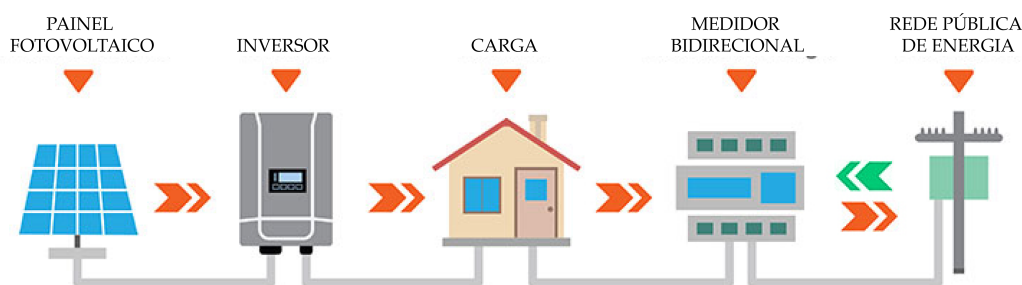
FIGURA 3. Sistema fotovoltaico conectado à rede.
