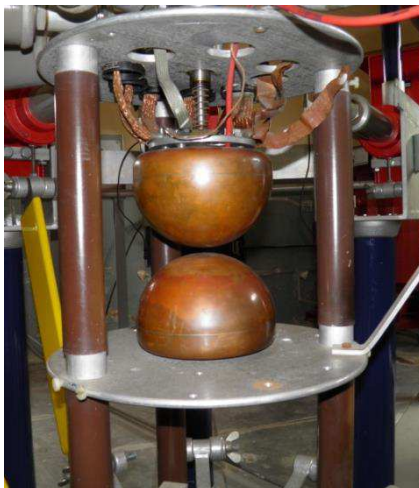
Figura 4 – Centelhador do gerador de impulso de corrente.
