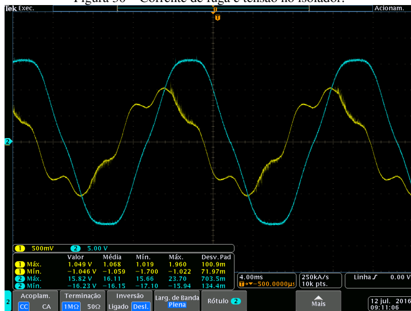
Figura 30 – Corrente de fuga e tensão no isolador.
