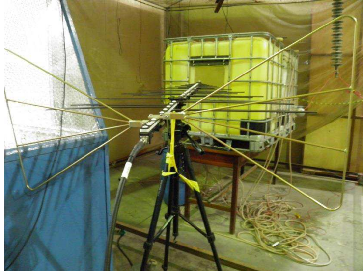
Figura 32 – Ensaio de medições de irradiação eletromagnética.
