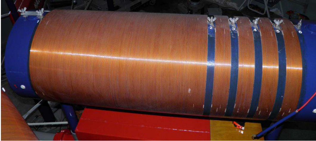
Figura 8 – Indutor do gerador de impulso e seus terminais numerados.
