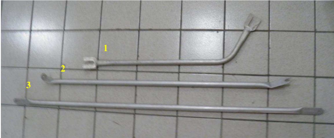
Figura 10 – Conectores 1, 2 e 3 de alumínio utilizado no gerador de impulso de corrente.
