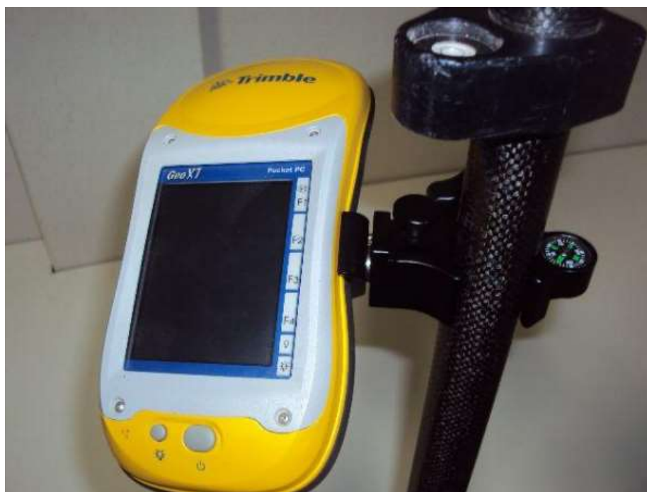
Figura 7: GPS GeoXT, utilizado na alocação dos piquetes.
