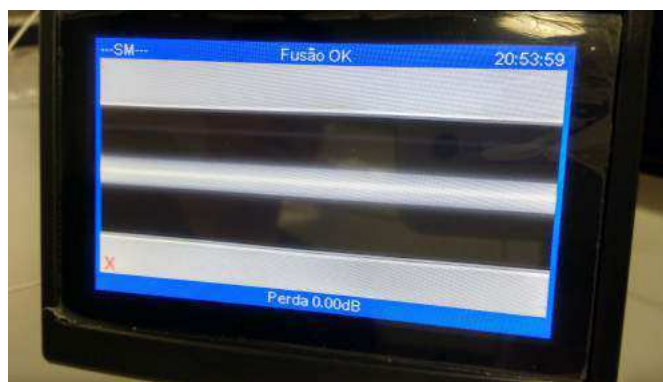
Figura 4.2: Fusão sendo realizada pela Máquina de Fusão
