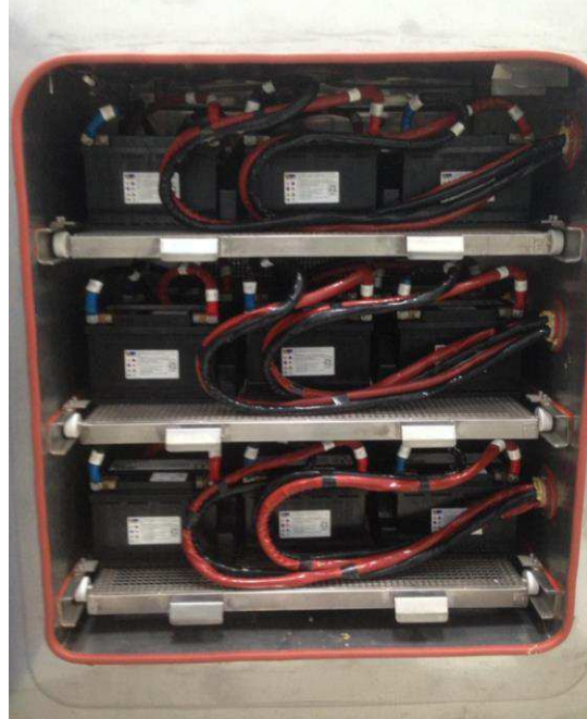
Figura 24. Conexão baterias para câmara climática.
