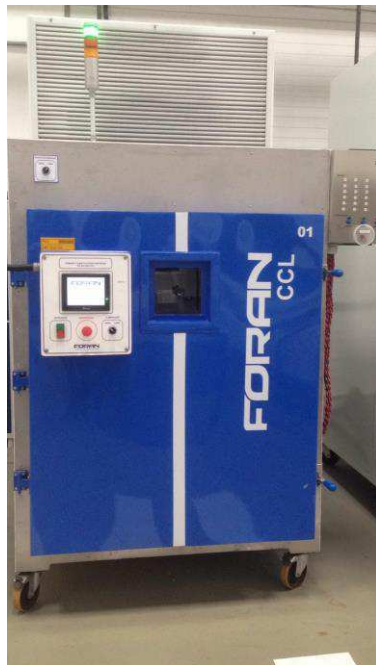
Figura 23. Câmara climática com capacidade de 18 circuitos.
